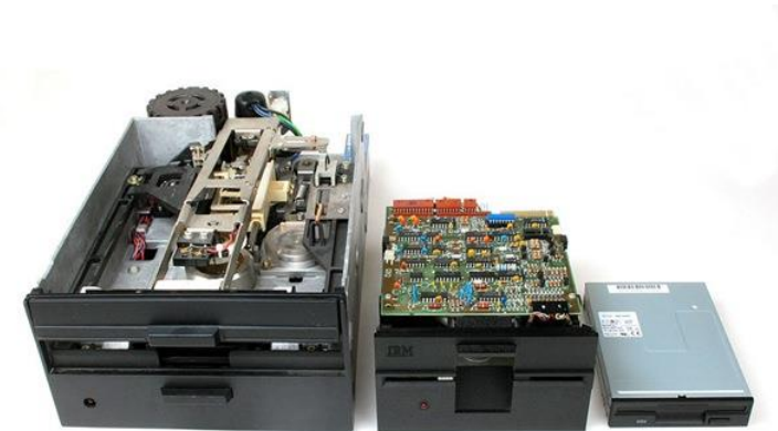
Abbildung 13.: Diskettenlaufwerke im Wandel der Zeit 8“, 5¼“ und 3½“
