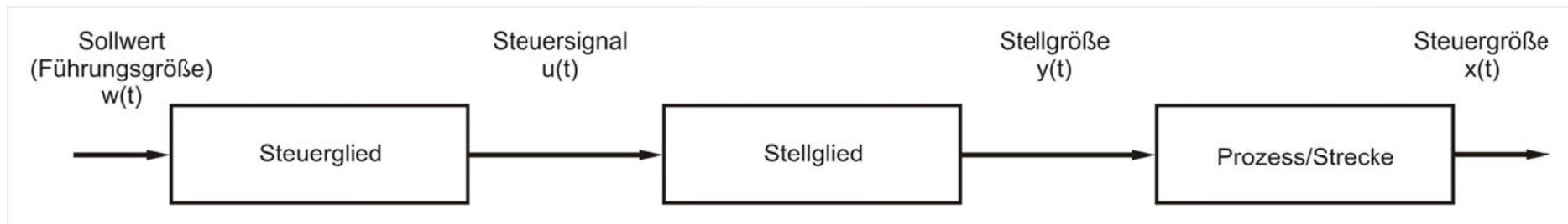
Abbildung 11: Wirkungskette einer Steuerung
